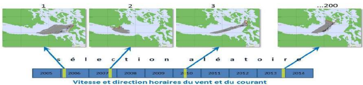
Figure E-4: Illustration de l'échantillonnage aléatoire des données sur le vent et le courant servant dans l'approche de modélisation stochastique
