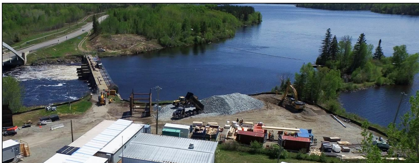
Figure 15 : Vue aérienne du barrage Latchford au début de la construction du nouveau barrage (image provenant de Google Maps). La barrière de voie navigable est visible. Il y a un accès à l'ancrage gauche par la bande de terre grâce à un chemin assez large pour une camionnette.
