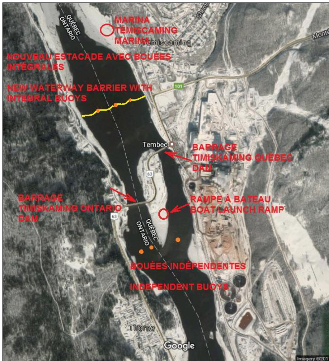
Figure 4 : Barrage Témiscamingue : emplacements approximatifs de la nouvelle barrière de voie navigable et des nouvelles bouées d'obstacles.
