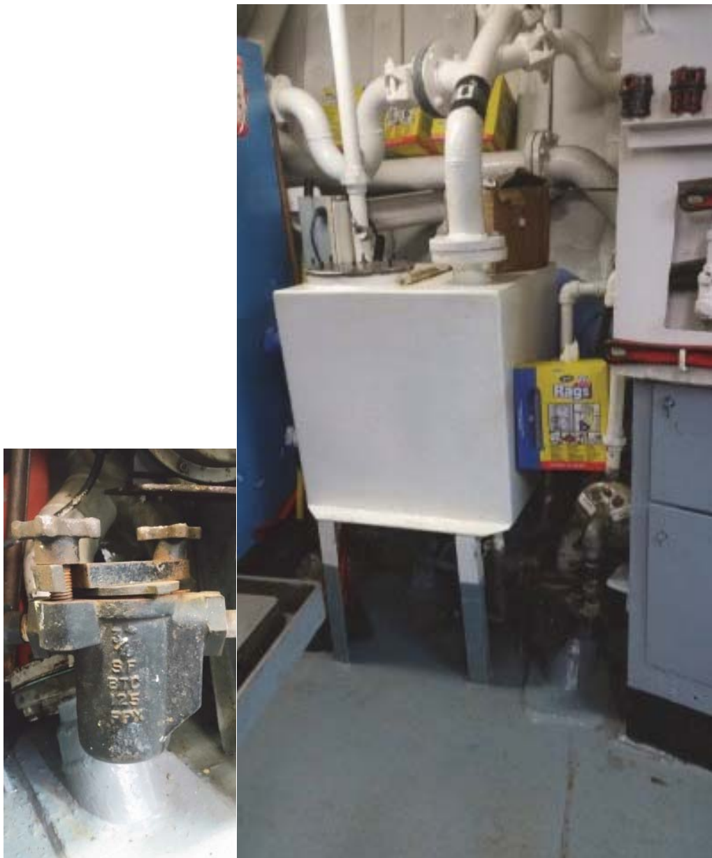
Épurateur (gauche) et réservoir (droite) d'eau grise du côté bâbord
