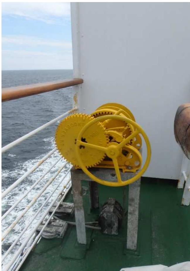
Figure3 : treuil bowsing avec poulies verticales et horizontales
