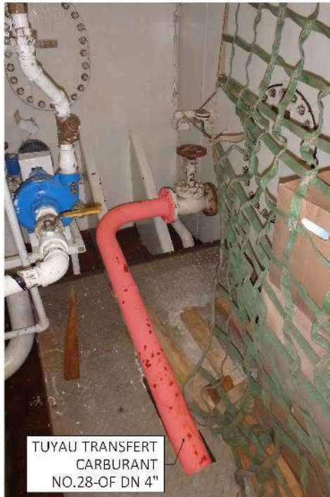
Figure 16 Transfert de carburant, raccord à la cloison 146
