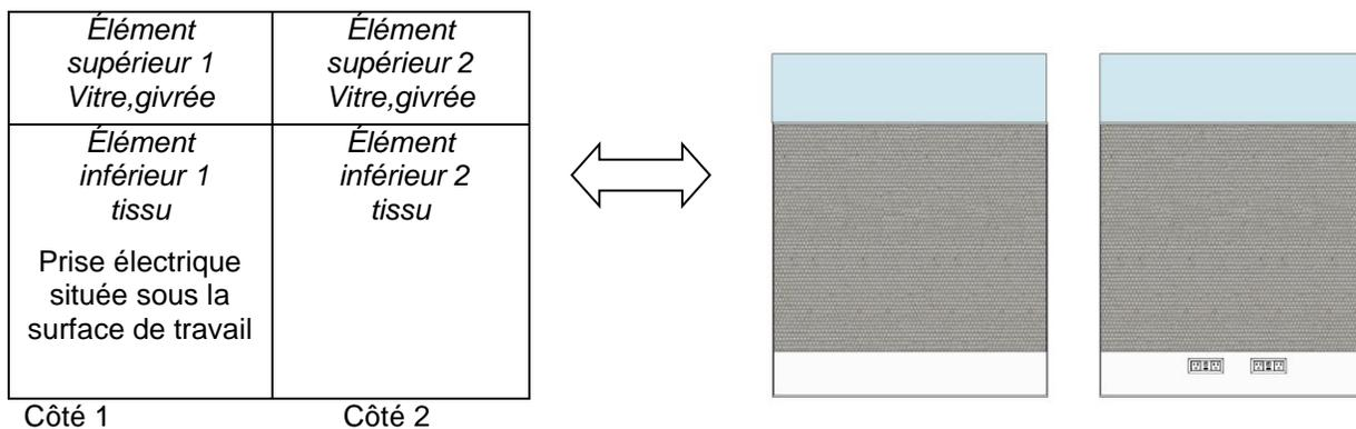
Matrice de panneaux C: Tissu des deux côtés avec élément supérieur vitrée, givrée
