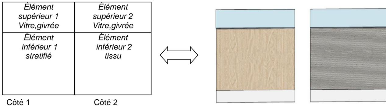
Matrice de panneaux E: Tissu d'un côté et panneaux stratifié de l'autre avec élément supérieur vitrée, givrée
