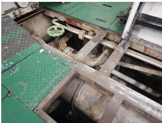
Valve #157 et tuyau de 14" du système d'assiette
