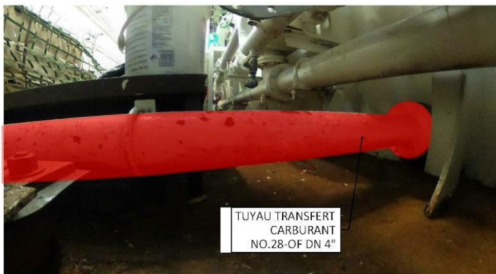
Figure 16 Transfert de carburant, raccord à la cloison 138
