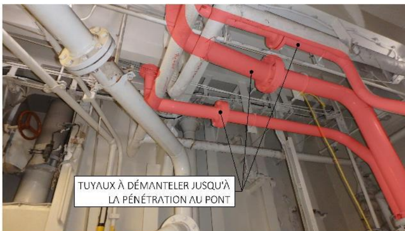
Figure 25 Tuyau d'eaux grises sous le pont à 17 pi
