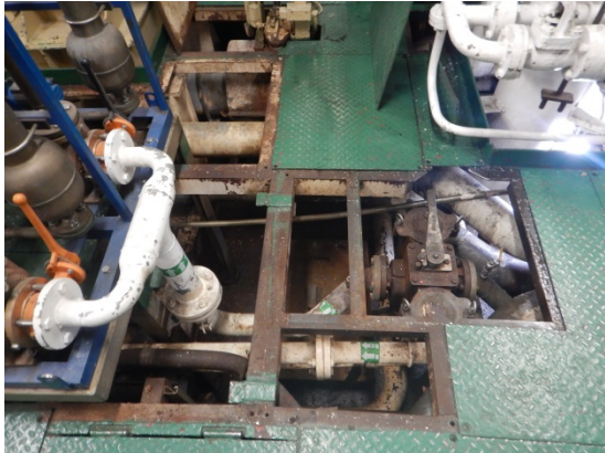
WQP aspiration et filtre duplex
