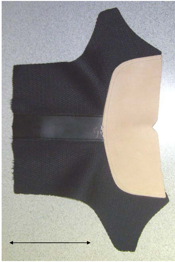
Figure 7: Doublure sans couture à l'arrière au-dessus du sous-contrefort (deux rangées de piqûres requises)
