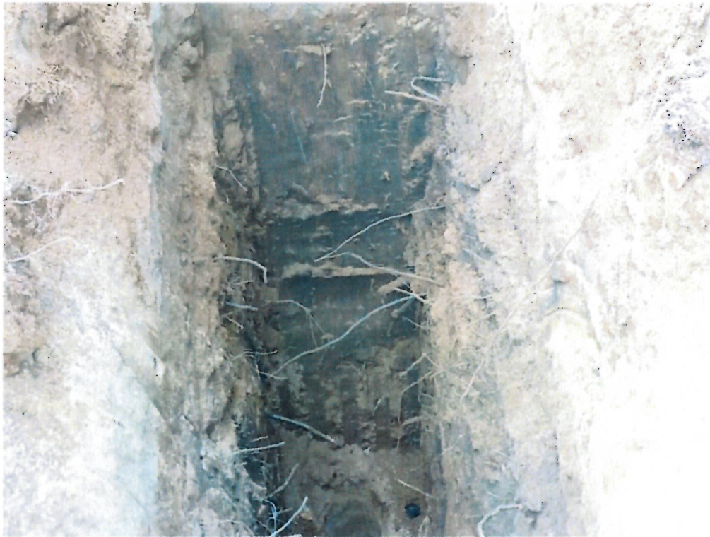
Vue de la stratigraphie des sols au sondage S-1
