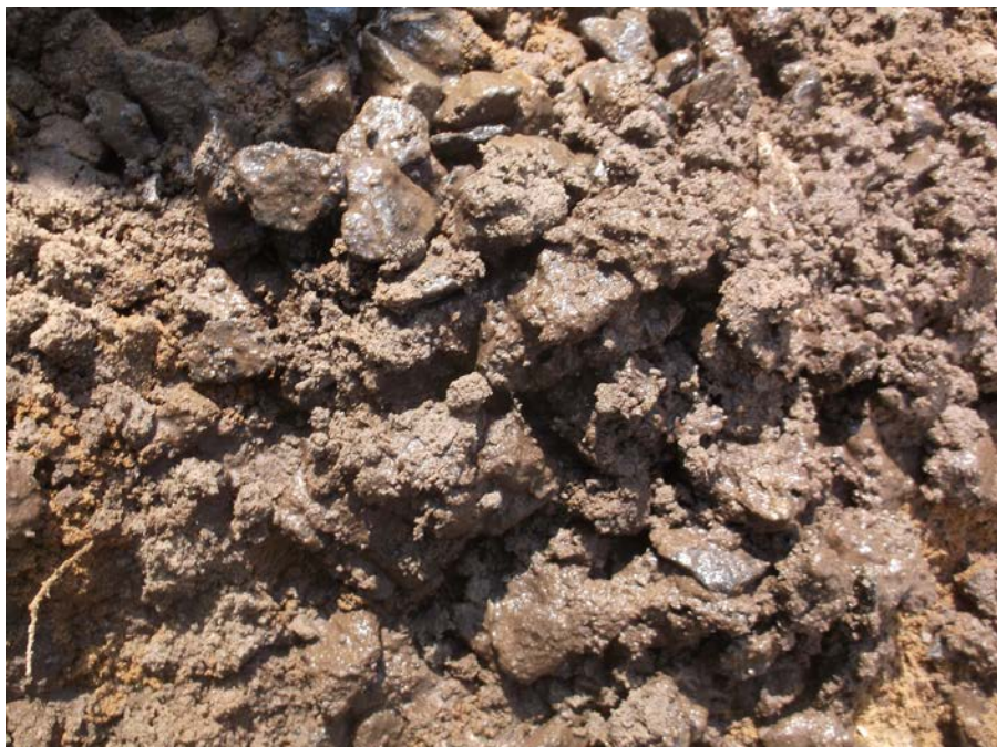
Photo 2 : Pierre 14-20 mm extraite du sondage S-3-2-4.
