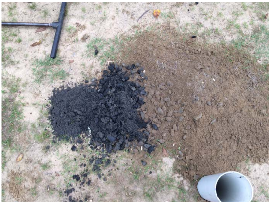
Photo 2 : Pierre 14-20 mm sale extraite du sondage S-4-2-4.
