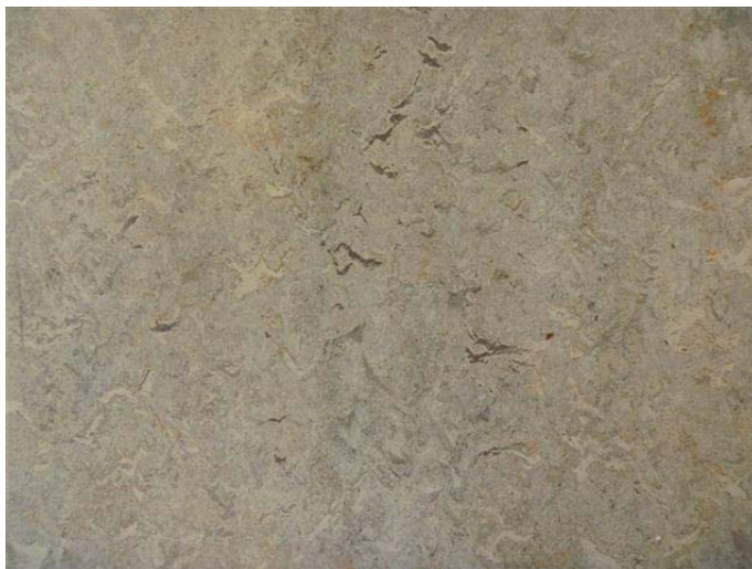
Photo 1 – Linoléum vert vagué de beige, de noir et de rose présent au rez-de-chaussée, sans amiante
