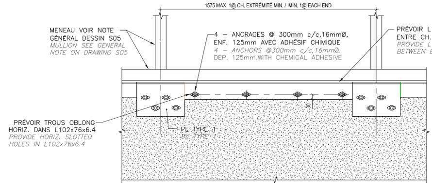
RÉALISER UNE DÉTECTION GÉORADAR DU BÉTON, ENSUITE LOCALISER LES ARMATURES EXISTANTES EN PLACE DANS LE BÉTON ARMÉ ET MARQUER À L'AIDE DE TRAIS LES ARMATURES LOCALISÉES. NE PAS COUPER D'ARMATURES LORS DU FORAGE DES ANCRAGES.
