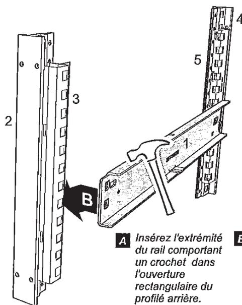
**A** Insérez l'extrémité du rail comportant un crochet dans l'ouverture rectangulaire du profilé arrière.
