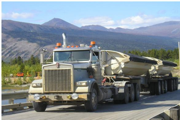
La traversée du pont de la rivière Nares à Carcross, au Yukon, a permis aux trains doubles de type Super B de l'entreprise Canadian Lynden Transport de transporter 53 tonnes de concentrés de cuivre de la mine Minto jusqu'au terminal à minerais de Skagway, en Alaska.
