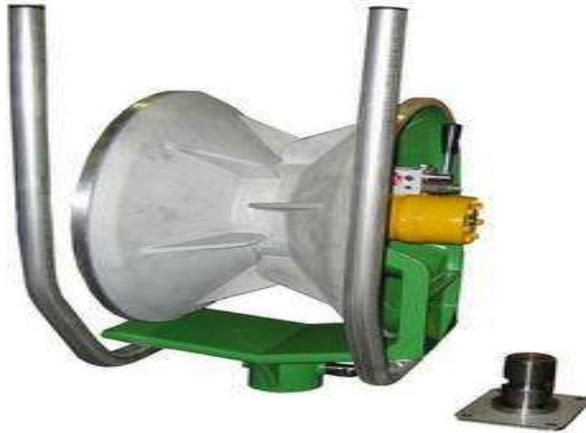
Le tambour à filet et la semelle qui est boulonnée sur le plat-bord. Le tambour peut tourner sur la semelle, mais il est fermement bloqué avant utilisation. Les montants sont illustrés à titre indicatif seulement. Les montants doivent pouvoir tourner à 360 degrés.
