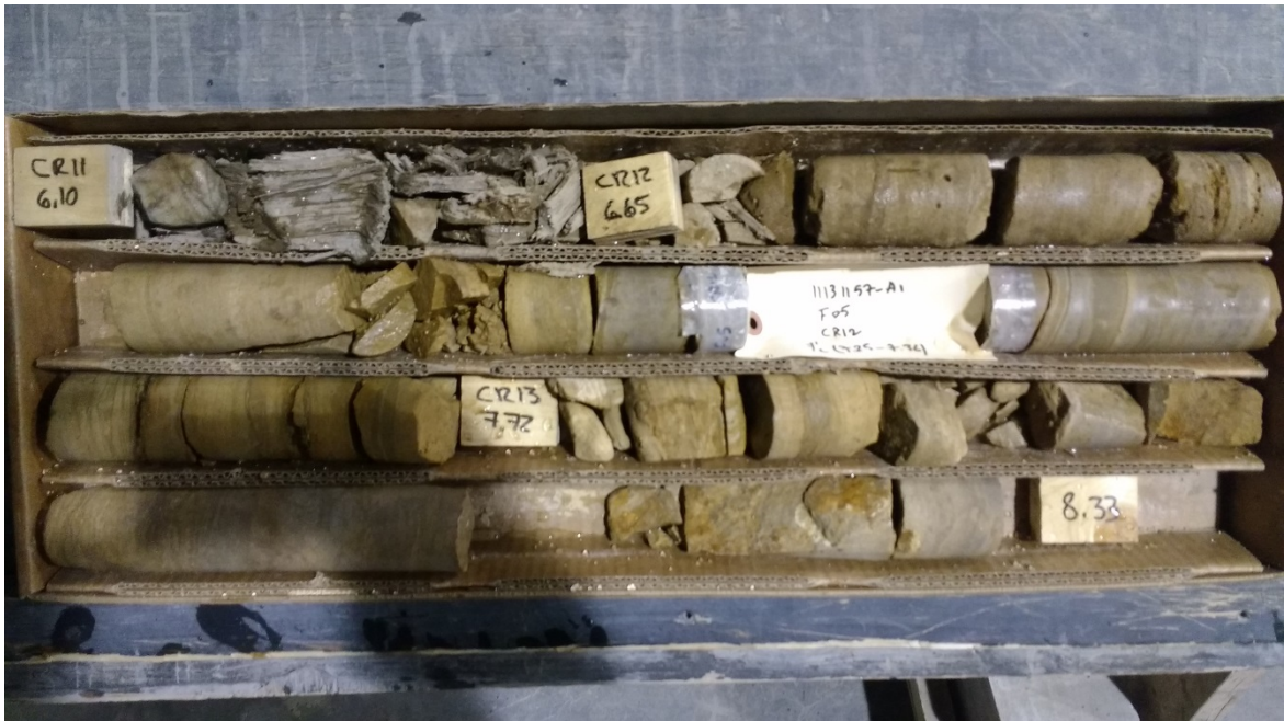
Photo 3 – Roc à l'emplacement du forage no F-05
