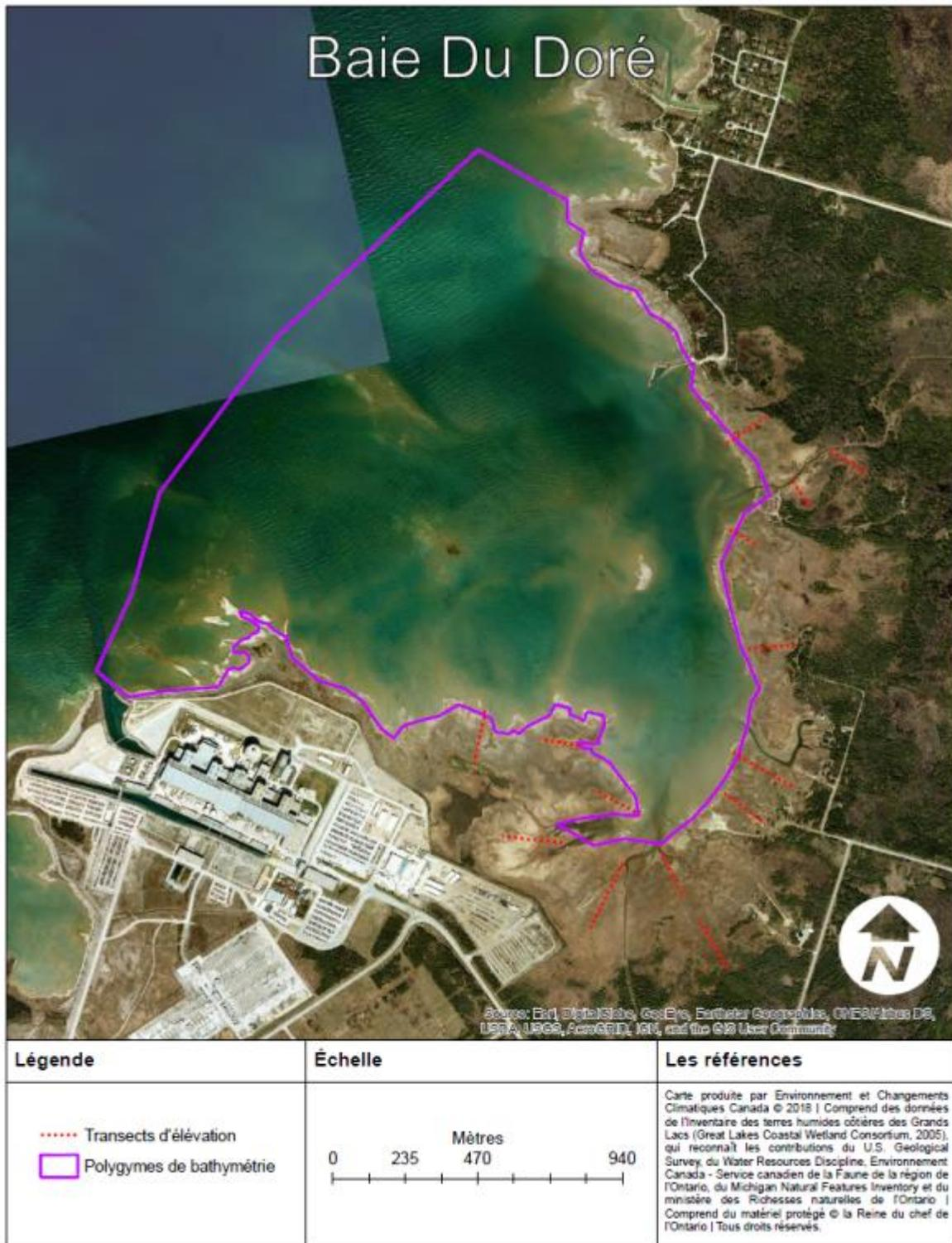
Figure 4. Carte illustrant la localisation des transects topographiques et l'étendue du polygone à l'intérieur duquel doit être réalisé les levés bathymétriques pour le site Collingwood Shores.
