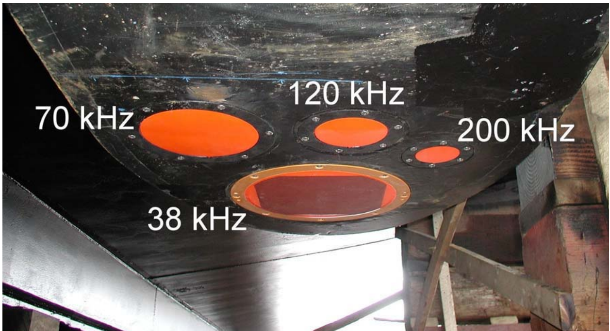
Photo 5. Vue de la base de la coupole et des transducteurs, vers l'avant.
