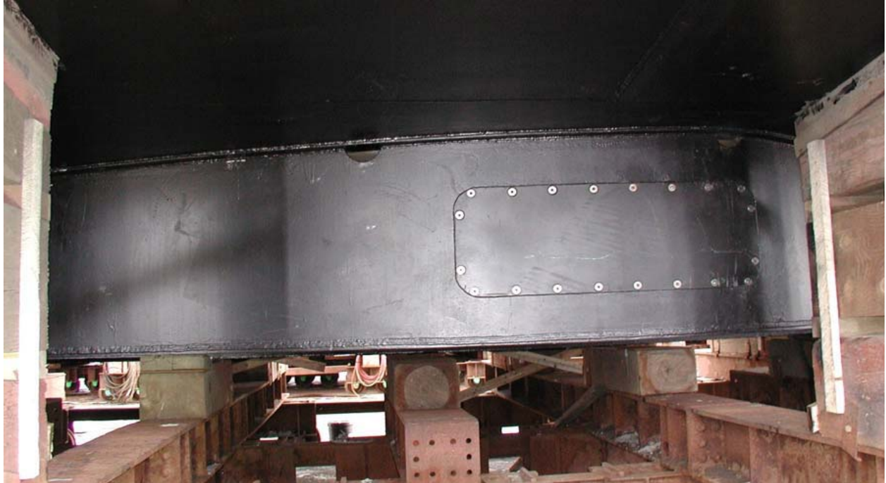
Photo 4. Vue du côté extérieur de la coupole montrant le transducteur et la plaque d'accès au câble.
