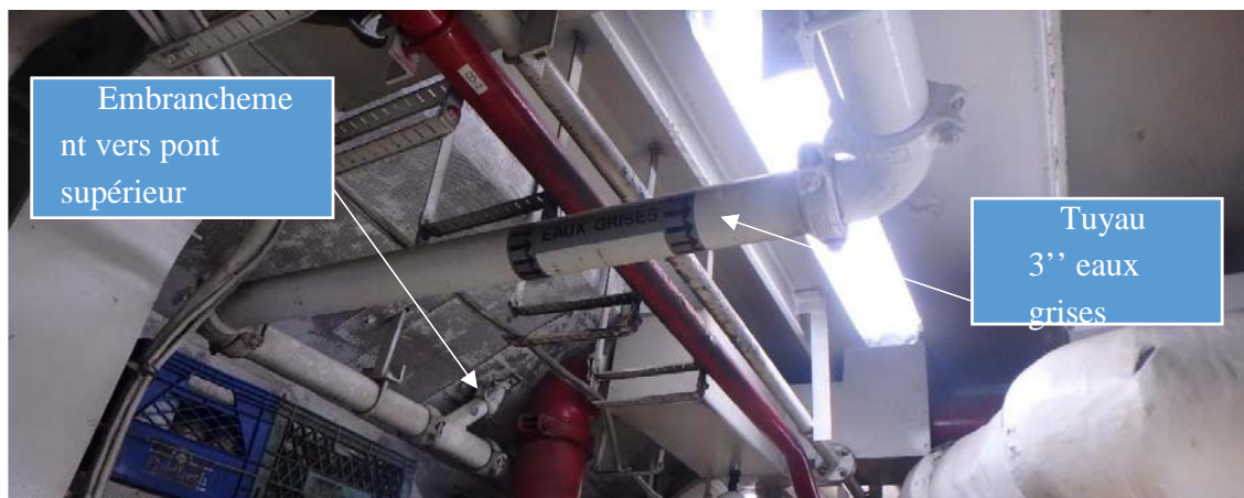
Photo no. 28 : Vue sous le plancher du pont principal, regardant vers l'arrière
