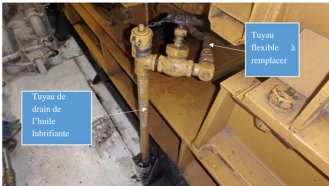
Photo no. 22 : tuyau de drain à huile, entre le moteur et bordé tribord
