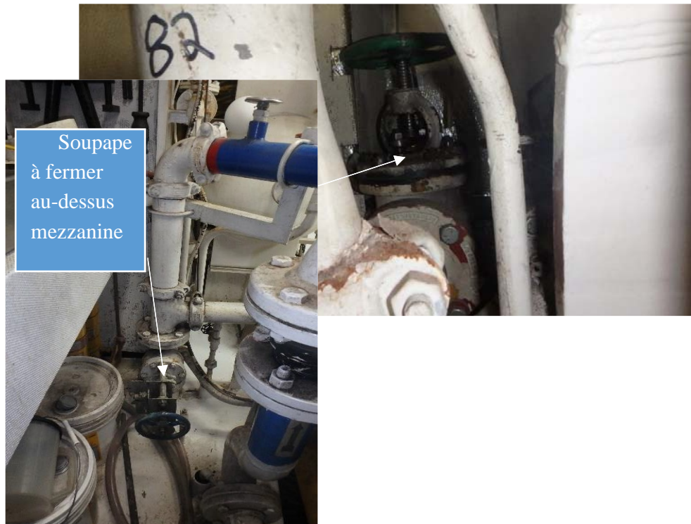
Photo no. 12 : soupape de refoulement à la mer, eau de mer de refroidissement (urgence)
