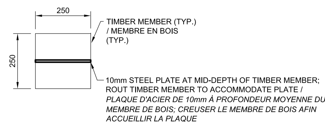
E COLUMN REPAIR DETAIL DÉTAIL DE RÉPARATION DE COLONNE
