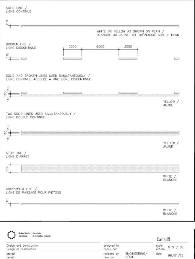
projet drawing PAVEMENT MARKING PATTERNS / dessin MARQUES SUR CHAUSSÉE
