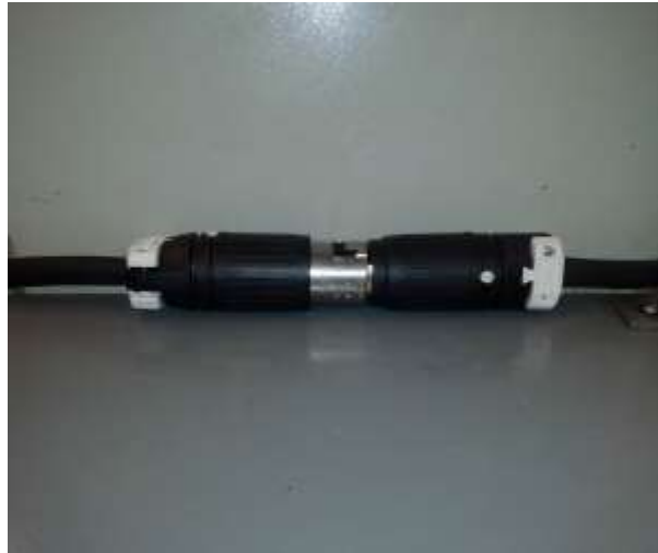
Figure 3-4 Fiche électrique utilisée avec une fraiseuse à commande numérique actuelle
