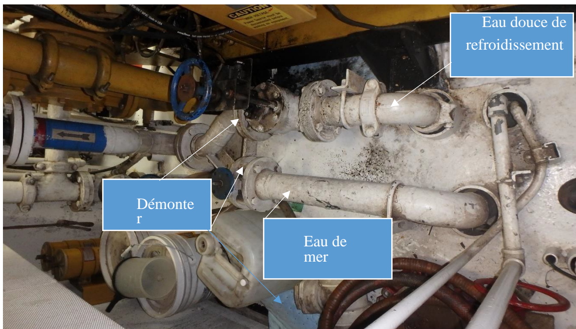
Photo no. 35 : tuyaux eau de mer et eau douce, entre bordé tribord et moteur Caterpillar, au pont inférieur (mezzanine) regardant vers l'arrière
