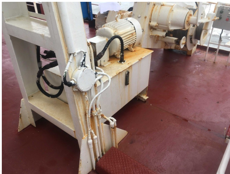
Photo 3 : Unité hydraulique du bossoir de la péniche et pénétration de pont
