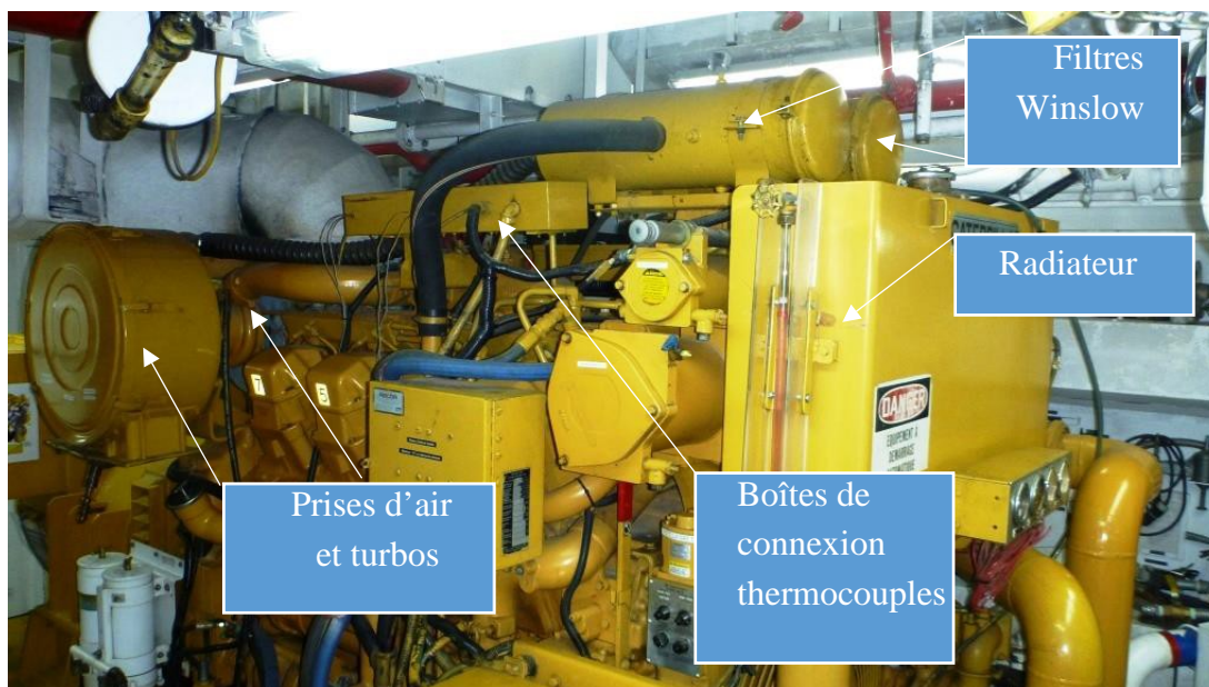
Photo no. 45 : éléments à enlever sur le diesel avant de le sortir
