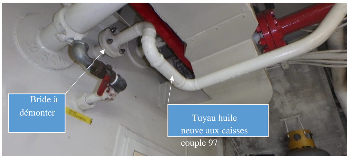
Photo no. 33 : à la cloison 97, bride à démonter
