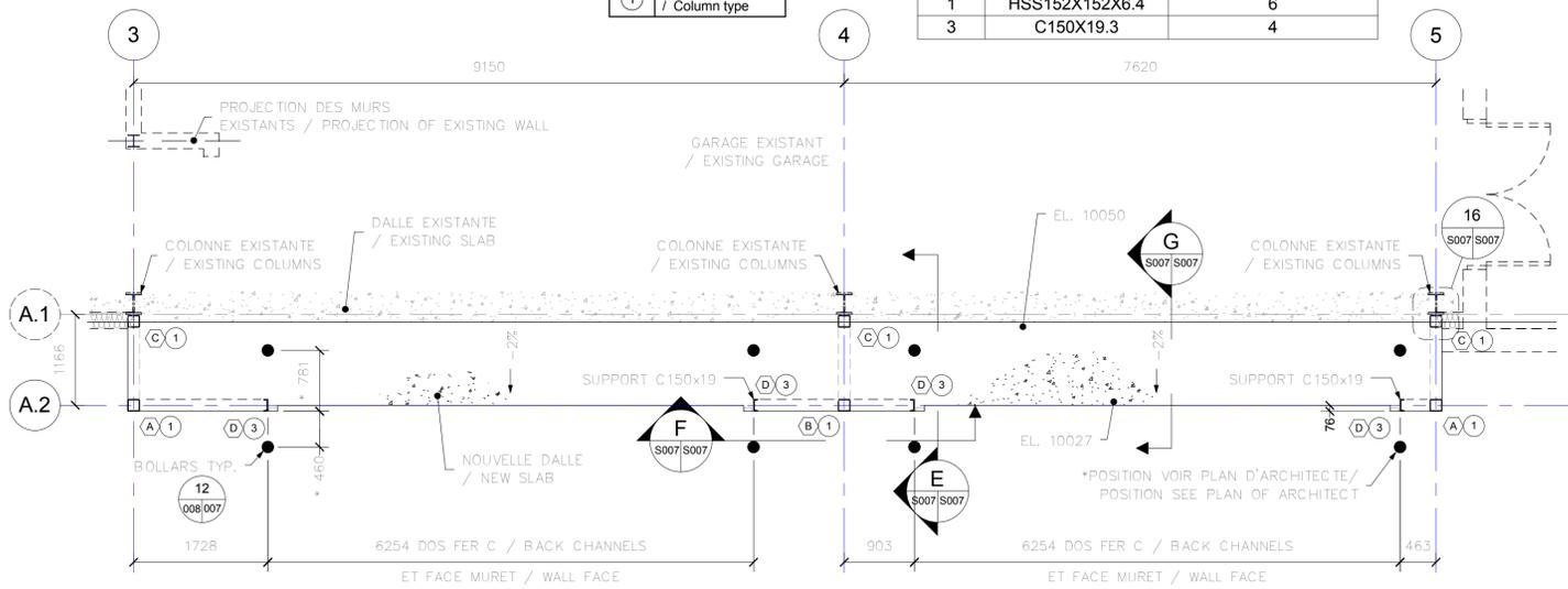
**VUE EN PLAN - R.D.C GARAGE / PLAN VIEW OF GARAGE FLOOR**
