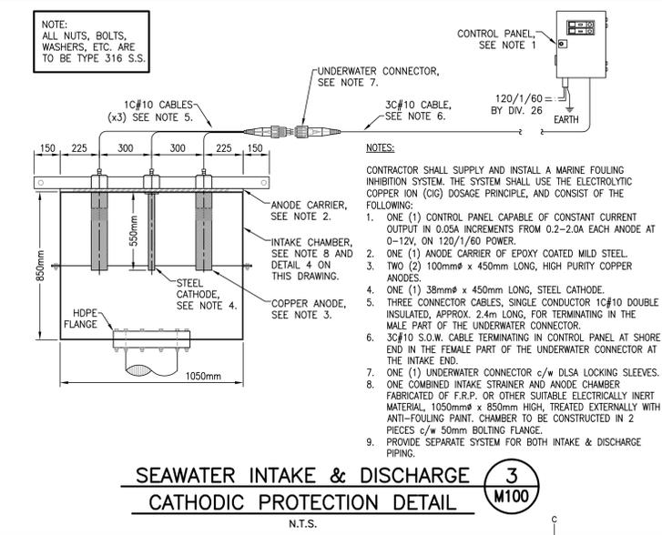
**SEAWATER INTAKE & DISCHARGE CATHODIC PROTECTION DETAIL 3**
