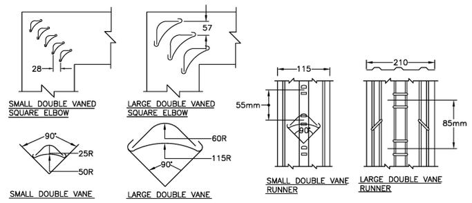
**VANED ELBOW CONSTRUCTION DETAILS**
