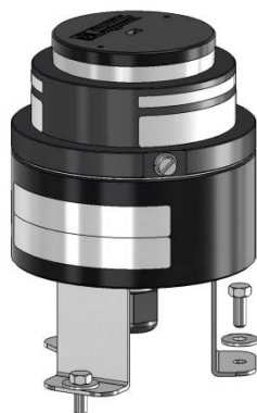
Abbildung 2 Befestigung auf horizontaler Fläche
