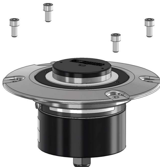
Abbildung 4 Befestigung der Einbauausführung
