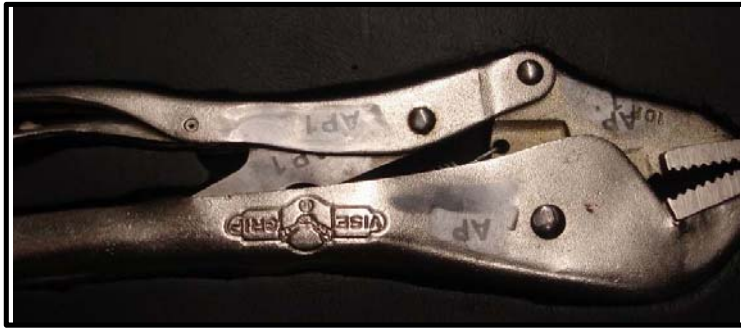
Photo 5: Toutes les pièces qui sont détachable de l'outil principal doivent être gravées au laser. Cette photo est un exemple.
