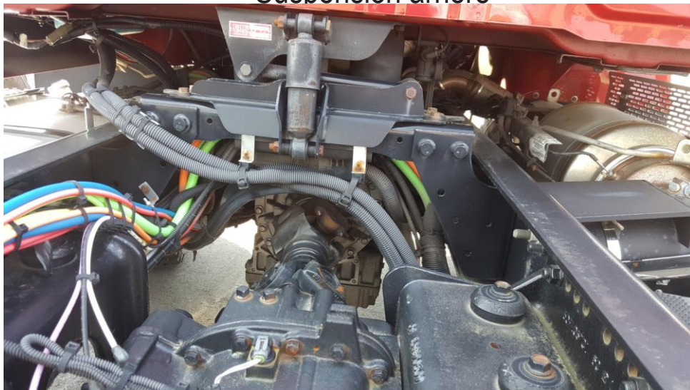
Rear view of drive shaft Vue arrière de l'arbre d'entraînement
