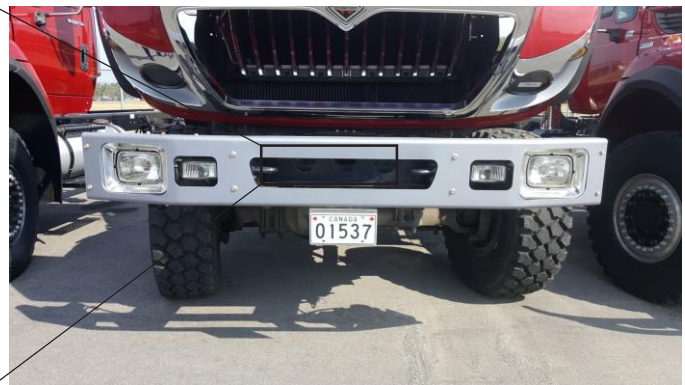
Front PTO Shaft Provision Disposition de l'arbre de PDF avant
