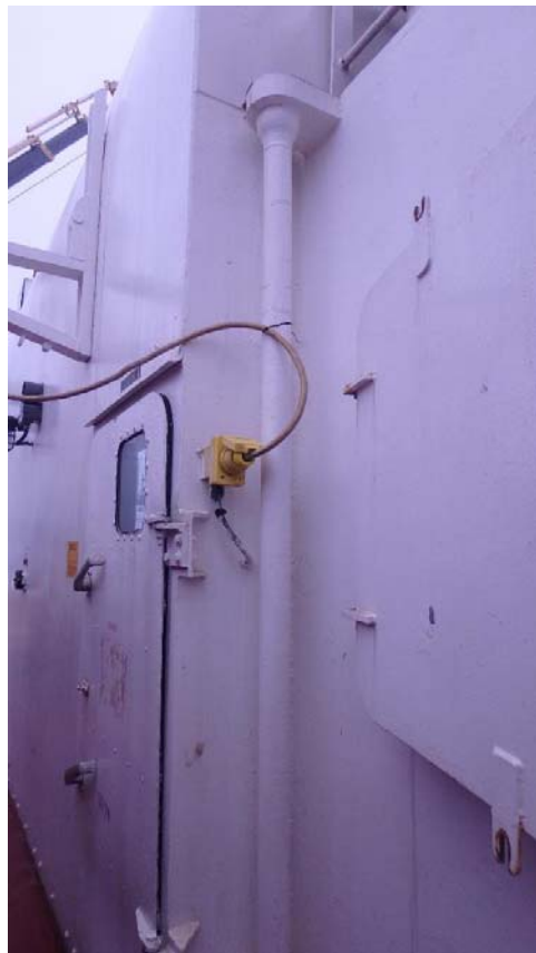
Figure 14: Drain tribord à démonter
