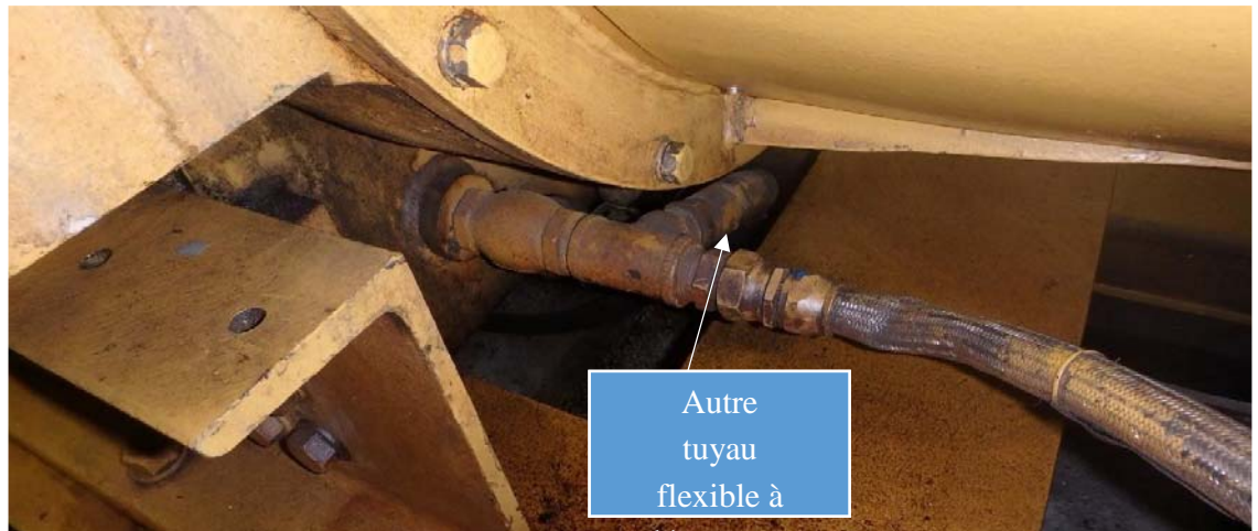
Photo no. 7 : déconnexion après tuyau flexible
