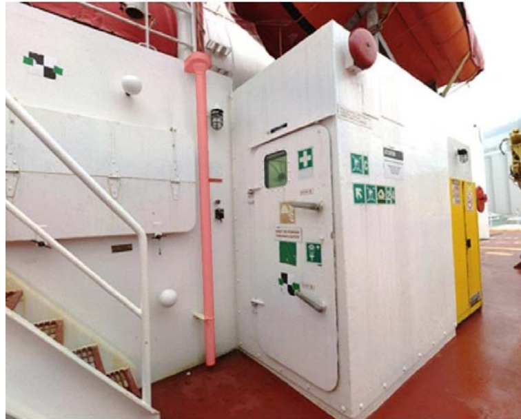
Figure 11: drain de pont à bâbord à démanteler
