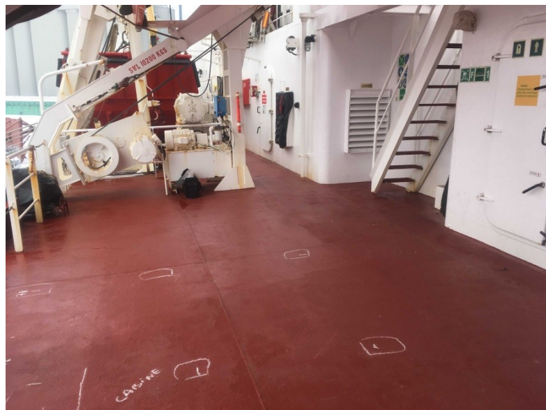
Photo 2 : Bras arrière du bossoir existant et unité hydraulique de la péniche de débarquement
