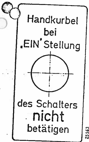
Fig. 3/2 Hinweisschild an der Not-Handkurbel
