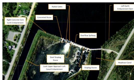
L'écluse est un sas simple de 53,3 m de longueur par 10 m de largeur. La profondeur de l'écluse, du couronnement au radier, est de 10,8 m.
