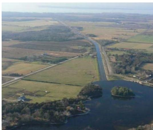
a. La digue nord-ouest a une longueur totale de 1 400 m dont les 12 premiers partent du barrage en béton constitué d'un noyau en béton. Le reste de la longueur est composé d'un noyau corroyé jusqu'à l'écluse.
