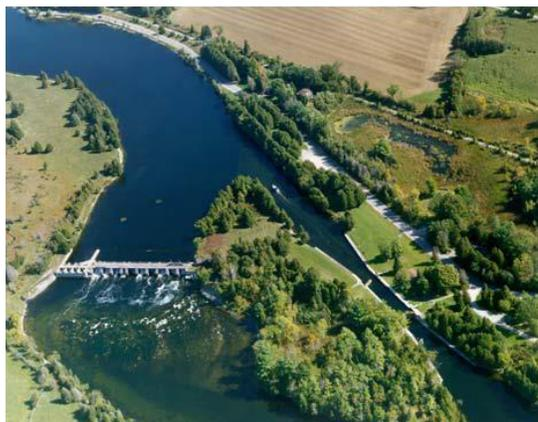
Portée : Le remplacement de la structure existante du barrage en entier, y compris le tablier, les piles, les culées, les poutrelles de vannage, les déversoirs, les musoirs en aval et en amont et les dalles d'approche est et ouest.
