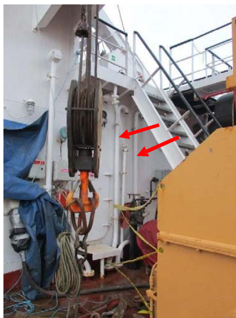
Photographie 2 - Cloison arrière du rouf indiquant l'emplacement des tuyaux de ventilation existants
