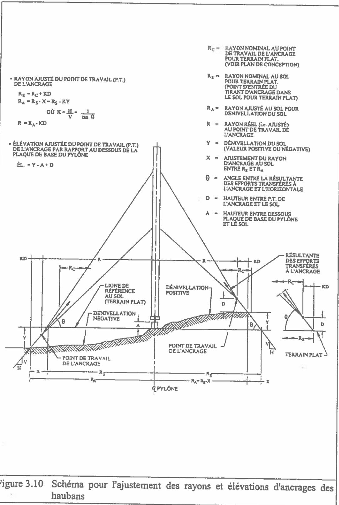
Figure 3.10 Schéma pour l'ajustement des rayons et élévations d'ancrages des haubans
