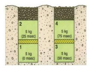
Selon la figure 1 : 20 kg de charge totale; délai de 25 ms entre les mises à feu et les trous de mine; superposition des charges. (Pêches et Océans Canada, 2015).
