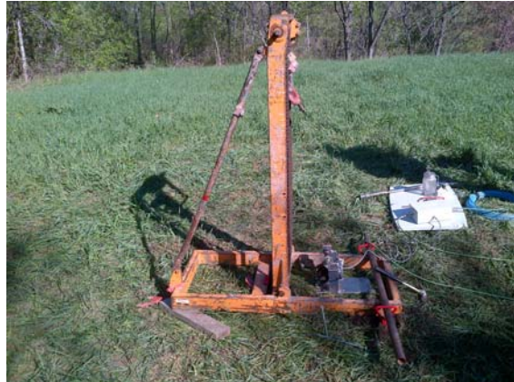
Conetec portable CPT rig.
