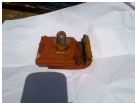
Exemple d'une patte de grille (brisée)
