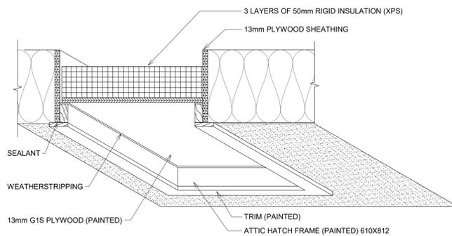
POSITION HATCH BETWEEN STRUCTURAL TRUSSES
