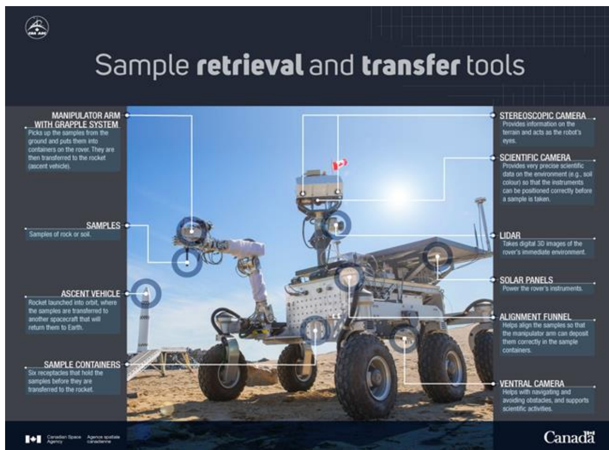
FIGURE 5-3 : CONFIGURATION DU ROVER DE LA MSRAD 2016, RÉCUPÉRATION DES ÉCHANTILLONS
