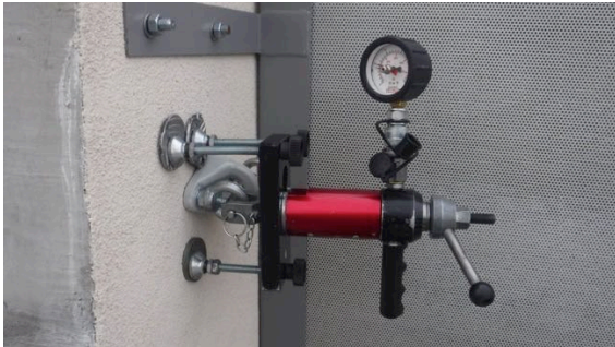
Essais de traction des ancrs structurelles des points d'ancrage.
