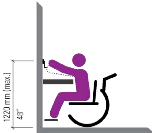
Figure 4.1.4b Portée avant par-dessus un obstacle
