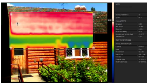
Figure 4 : Façade ouest du toit (température maximale de 66,7 °C)
