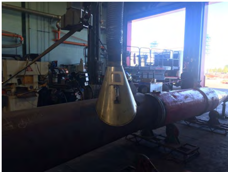
Photo 12 : Frottis de surface effectué sur un équipement – Échantillon prélevé sur l'embout du système d'aspiration (éch.# E-2, C > 11 \mu\text{g}/100 \text{ cm}^2 )
