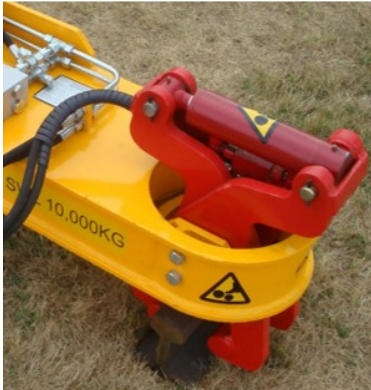
Figure 23 : Exemple de dispositif d'ancrage hydraulique
