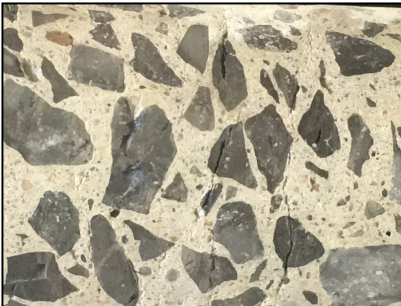
Carotte F6. Plusieurs fissures traversant les granulats.
