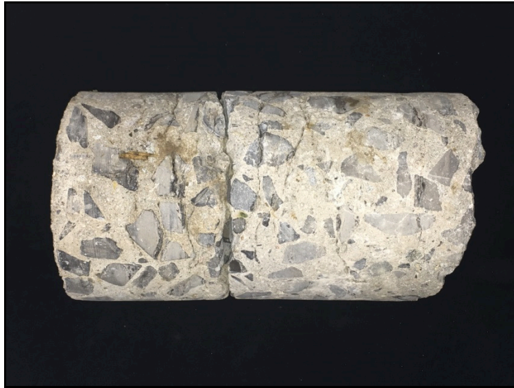
Carotte F4. Partie supérieure de la carotte de béton montrant de larges fissures ainsi que ce qui ressemble à du bois dans la carotte.
