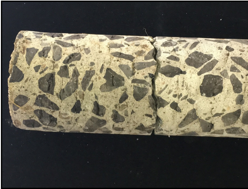
Carotte F8. Plusieurs fissures traversant les granulats.
