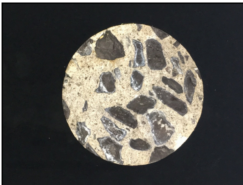
Carotte F8. Gel de silice au pourtour des granulats.
