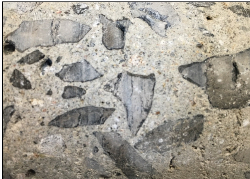
Carotte F1. Gel de silice autour des granulats indiquant une réaction alcalis-granulat. Des gels de silice sont aussi présents dans les vides du béton.
