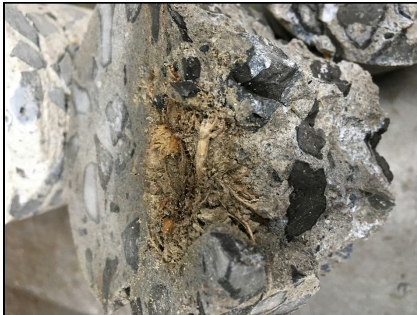
Carotte F4. Après le bris en compression, on voit clairement du bois dans le béton.
