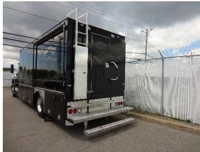
44. Le pare-chocs et les marchepieds arrière doivent être recouverts d'une plaque en losange de 3/16 po d'épaisseur antidérapant.
