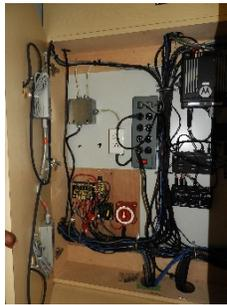
87. La paroi séparant les deux compartiments doit comporter un passage de câble de 6 po recouvert d'un panneau d'aluminium, conformément à la photo ci-dessus (derrière le siège).
