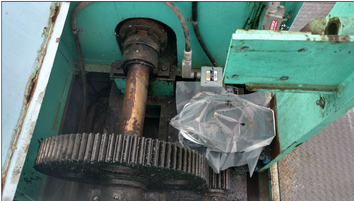
Figure 19 - Moteur n° 1, boîte de renvoi d'angle enlevée et feuille de protection en plastique placée sur le réducteur à vis sans fin (ouvrage de 2017).
