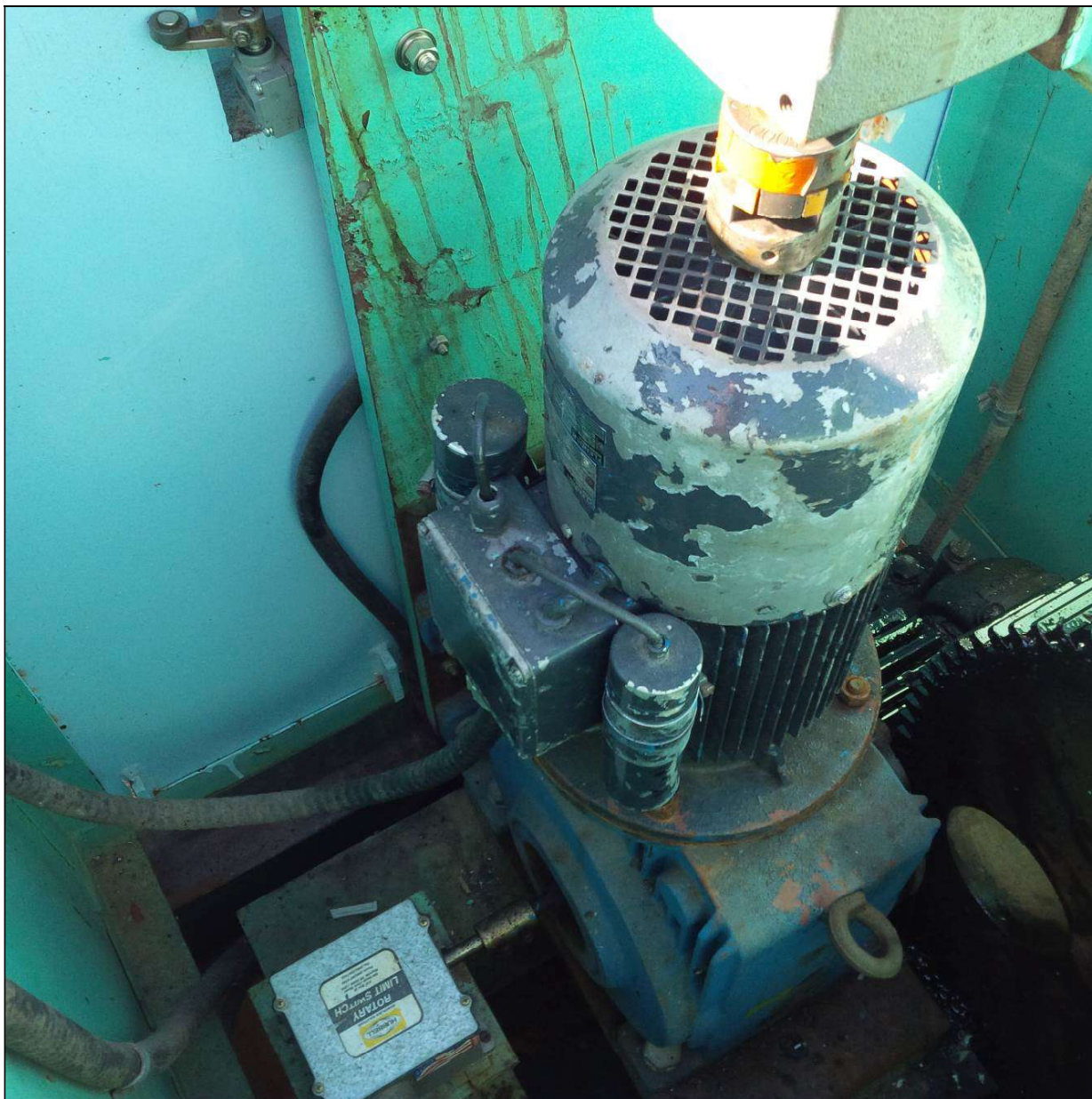
Figure 17 - Vue d'en haut du moteur installé entre la boîte de renvoi d'angle en haut et le réducteur à vis sans fin en bas. Encodeur rotatif visible à la gauche du réducteur à vis sans fin.
