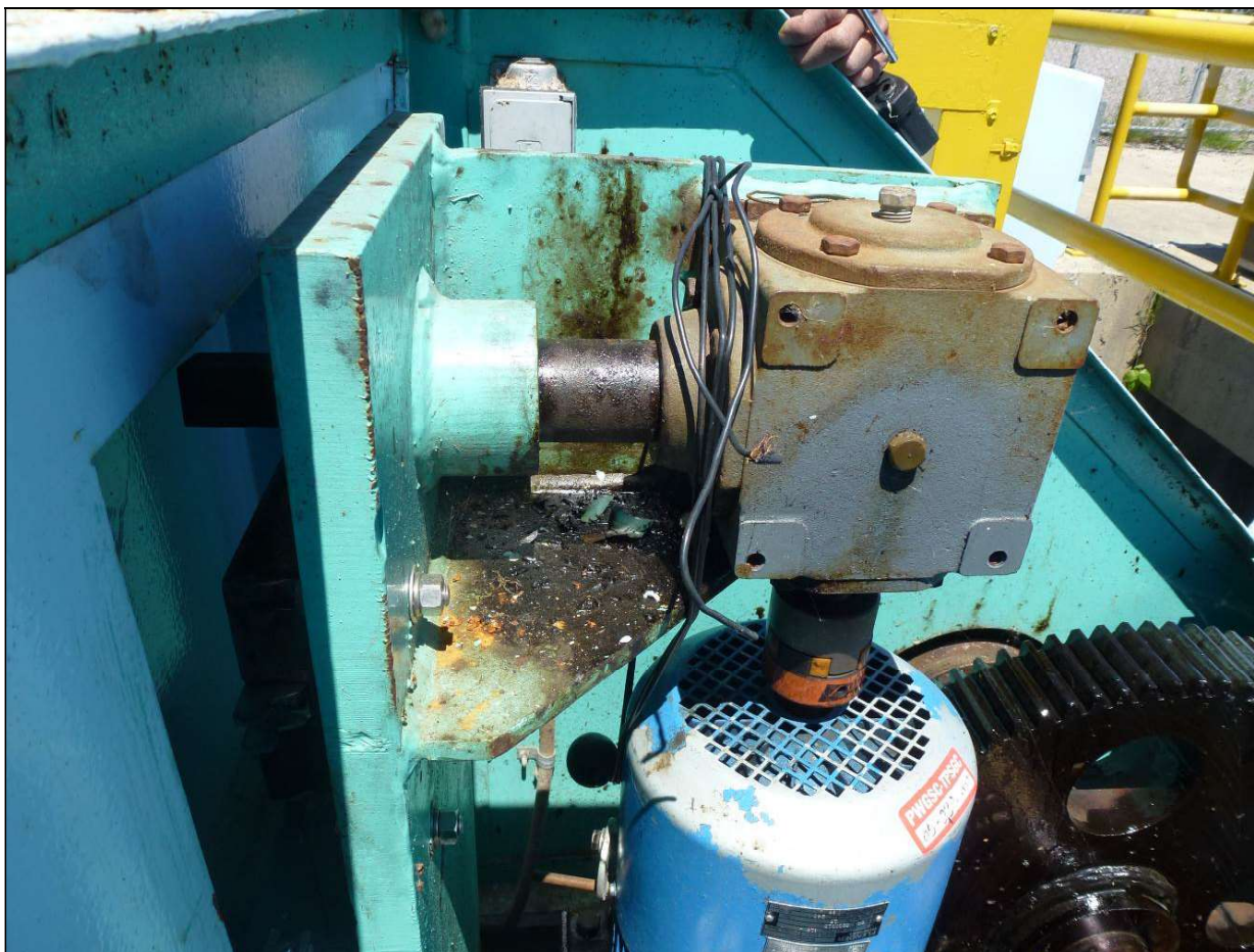
Figure 25 – Boîte de renvoi d'angle Hub City soutenue par le carter sur le dessus du moteur.
