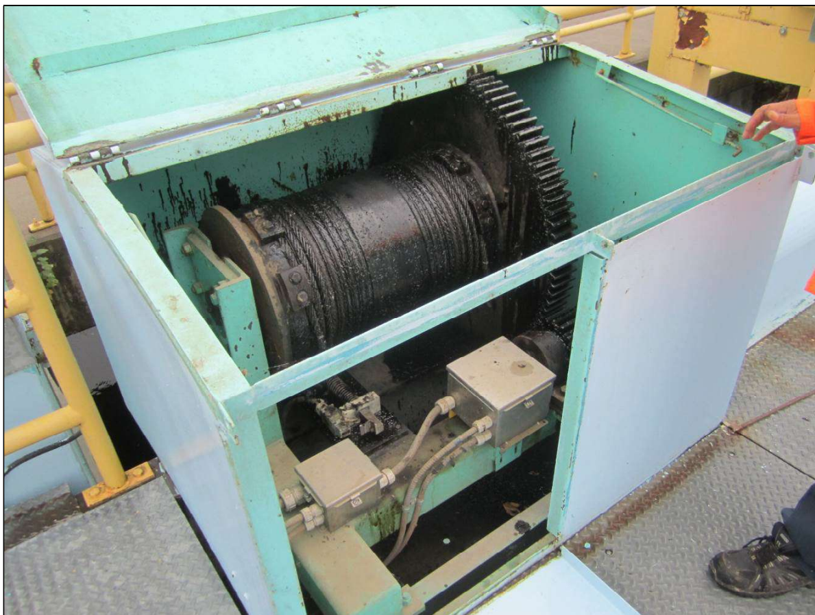
Figure 20 - Tambour du câble métallique. Chaque appareil de levage est muni de deux de ces tambours. Limiteur de jeu du câble visible en dessous, à la gauche du tambour.
