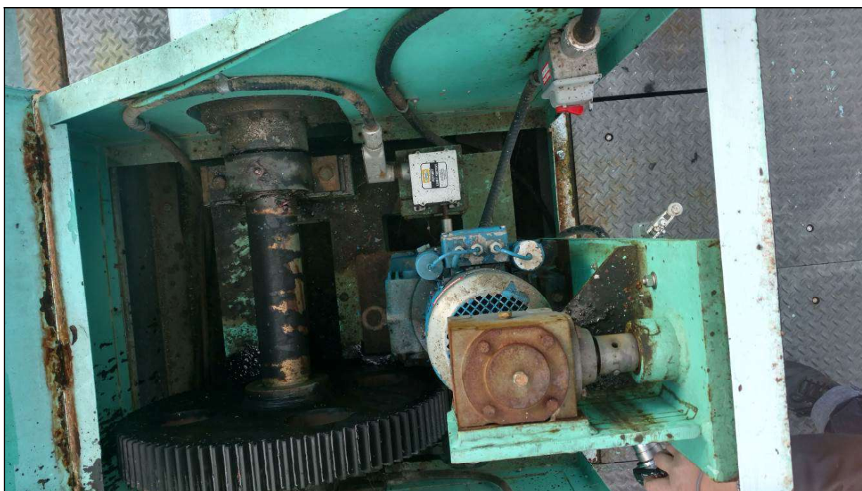
Figure 16 - Vue d'en haut de l'enceinte de l'appareil de levage. La figure nous montre le moteur n° 2, mais le moteur
