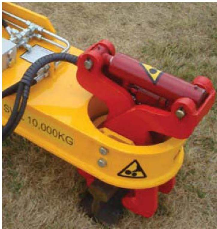
Figure 23 : Exemple de dispositif d'ancrage hydraulique
