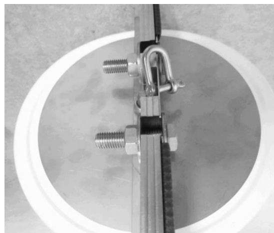
Fig. 13 : Réglage de la surpression de 3 à 5 mbar, ÜU-TT 150
