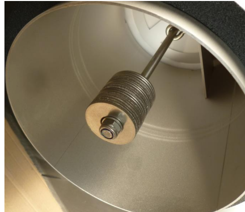
Fig. 14 : réglage de la sous-pression, ÜU-TT 150
