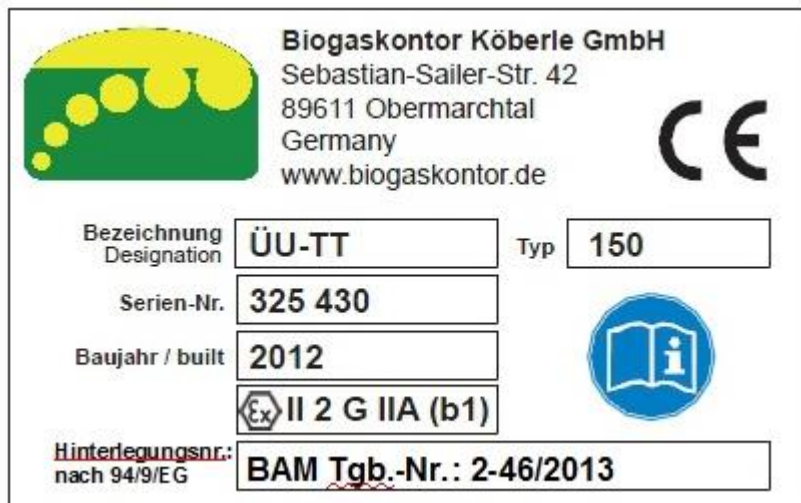
Fig. 31: plaque signalétique du régulateur de pression ÜU-TT (exemple ÜU-TT 150)
