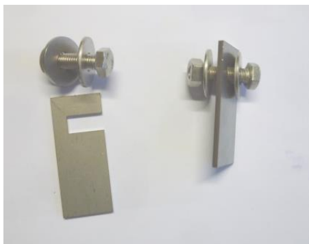
Fig. 13 : Réglage de la surpression de 3 à 5 mbar, ÜU-TT 150
