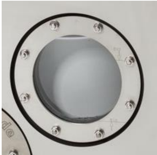
Fig. 23: indication du niveau de remplissage – chambre inférieure
