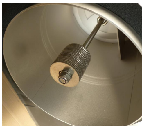
Fig. 16: Réglage de la sous-pression, ÜU-TT 200
