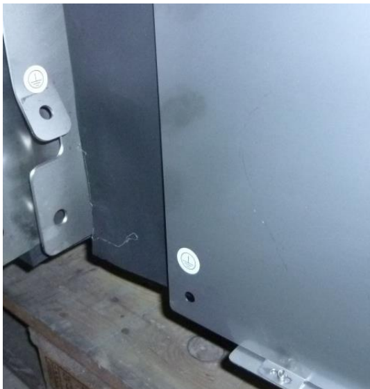
Fig. 8 : possibilité de raccordement pour la ligne équipotentielle
