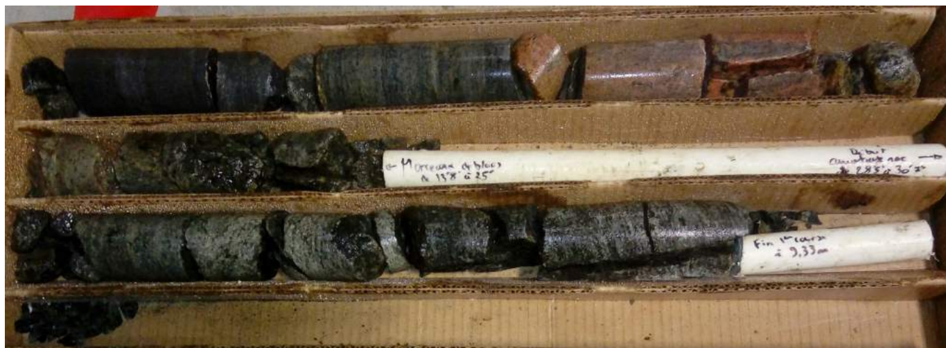
PHOTO 8 Forage 18F02 – Matériel récupéré entre 4,17 m et 7,62 m & CR7 (8,66 m à 9,32 m) – Carottes de roc mouillées
