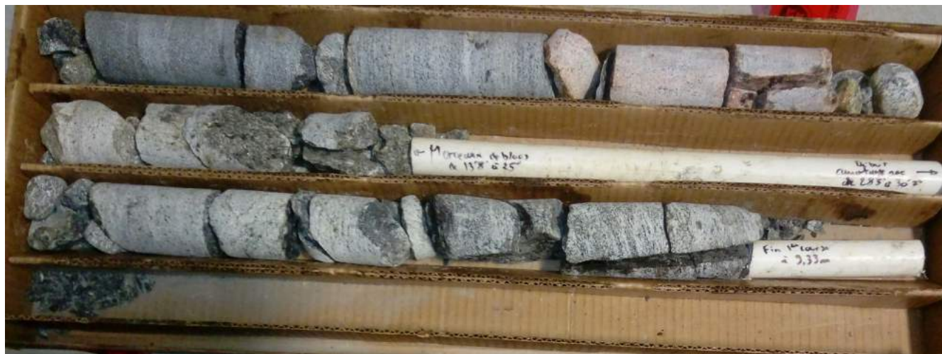
PHOTO 7 Forage 18F02 – Matériel récupéré entre 4,17 m et 7,62 m & CR7 (8,66 m à 9,32 m) – Carottes de roc sèches
